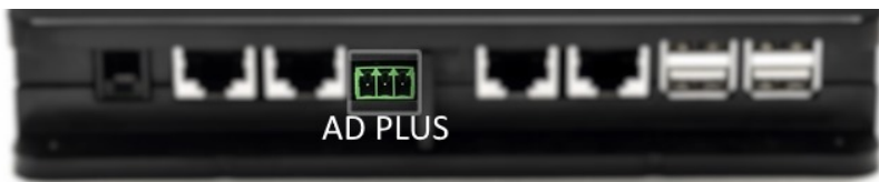
Figura 9A – Posición del conector en AD plus y en DConnect Box. Por ej., conexión del cable recto can-bus, nombre del conector DConnect Box para conexión con AD plus
